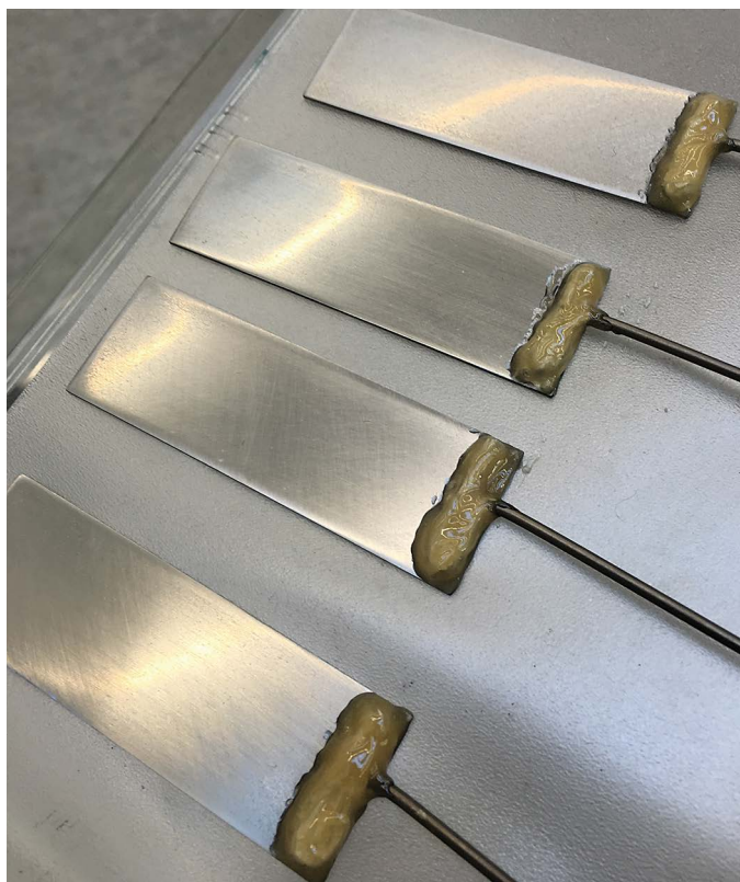
Billederne viser stålplader før og efter, at de i en måned er blevet udsat for metanogene arkæer i laboratorieforsøg. Fotos: Satoshi Kawaichi
