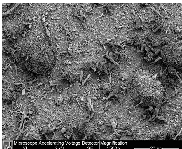
Indersiden af en sonde fra et spædbarn optaget med scanning elektronmikroskop ved 1500 X forstørrelse. Indersiden af sonden er helt dækket af en biofilm af celler – både humane celler og bakterieceller. Bakterierne ses som små kugler og stave, som også dækker de humane celler (de større klumper).
