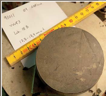
En lerprøve samt et apparat til måling af kvældetryk.
