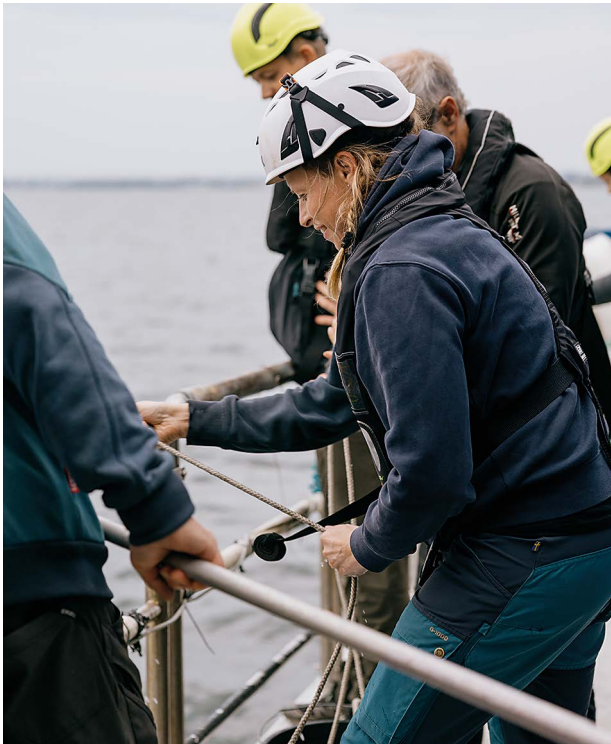
Katrine måler lydhastigheden gennem vandet som bruges i efterbehandlingen af data fra hydrofonerne. Foto: Andrea Lif, AU Foto
