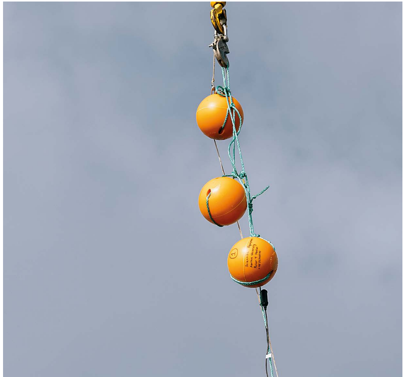
En hydrofon til måling af støjen hænger under nogle netflåd. En lille kran sænker det hele ned i vandet. Foto: Andrea Lif, AU Foto
