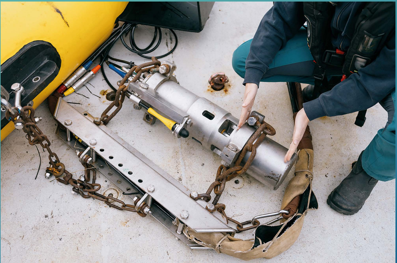
Udstyret spiller en afgørende rolle for forskningen, når Katrine Juul Andresen er på feltarbejde på havet. På billedet ses en luftkanon, der har en af hovedrollerne i at aflure undergrunden under havbunden sine hemmeligheder. Foto: Andrea Lif, AU Foto
