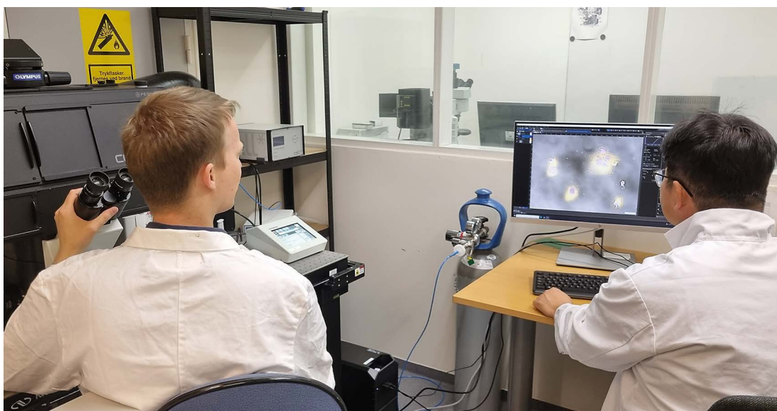
Mingdong Dong og Lasse Hyldgaard Klausen studerer her fluorescens-mærkede pattedyrceller. Instrumentet er et såkaldt inverteret mikroskop, hvor prøven belyses ovenfra, mens objektivet er monteret under prøven, så den betragtes nedefra. Sådanne mikroskoper bruges normalt til at lave billeder af levende celler, og i den sorte boks til venstre kan man kontrollere forhold som temperatur, CO 2 -niveau mv. Foto: Jørgen Dahlgaard
