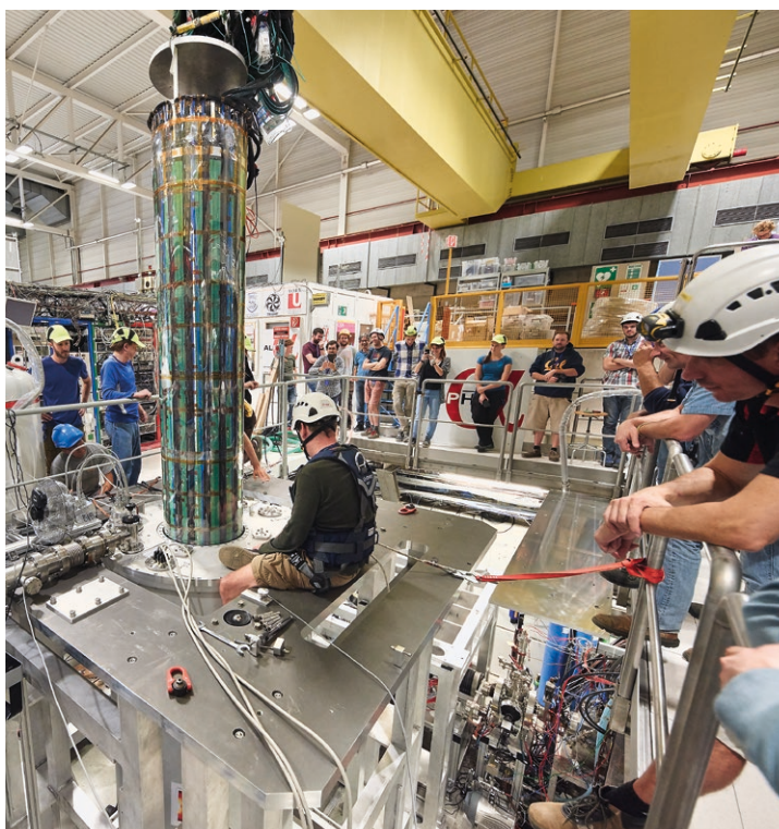
Indsættelse af ALPHA-g annihilationsdetektoren, der måler positionen af antihydrogen-annihileringerne, når atomerne slipper ud. Foto: CERN
