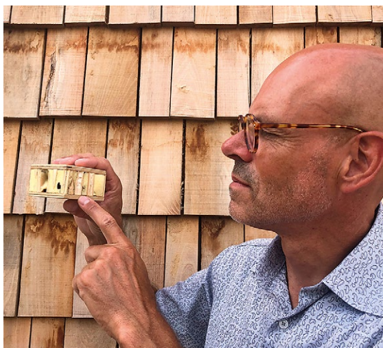
Torben Valdbjørn Rasmussen fremviser et element bestående af letvægtsplader af krydsfiner med en kerne af strå. Foto: Carina Liesk
