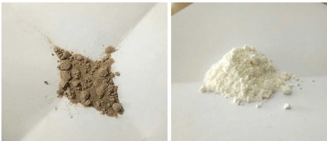
Calciumphosphat produceret fra rejeftvand fra Aaby renseanlæg uden oxidation (venstre) og med oxidation med hydrogenperoxid (højre). Den mørke farve skyldes organisk materiale. Fotos: Liubov Vasenko.
