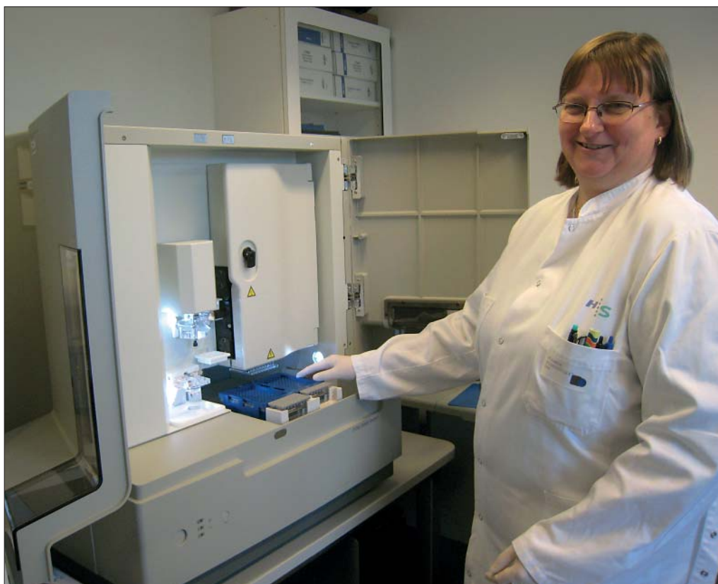
Bioanalytiker Pia Poss arbejder med sekventeringsmaskinen på Klinisk Mikrobiologisk Afdeling på Rigshospitalet for at identificere bakterier på baggrund af deres 16S rRNA gen.
