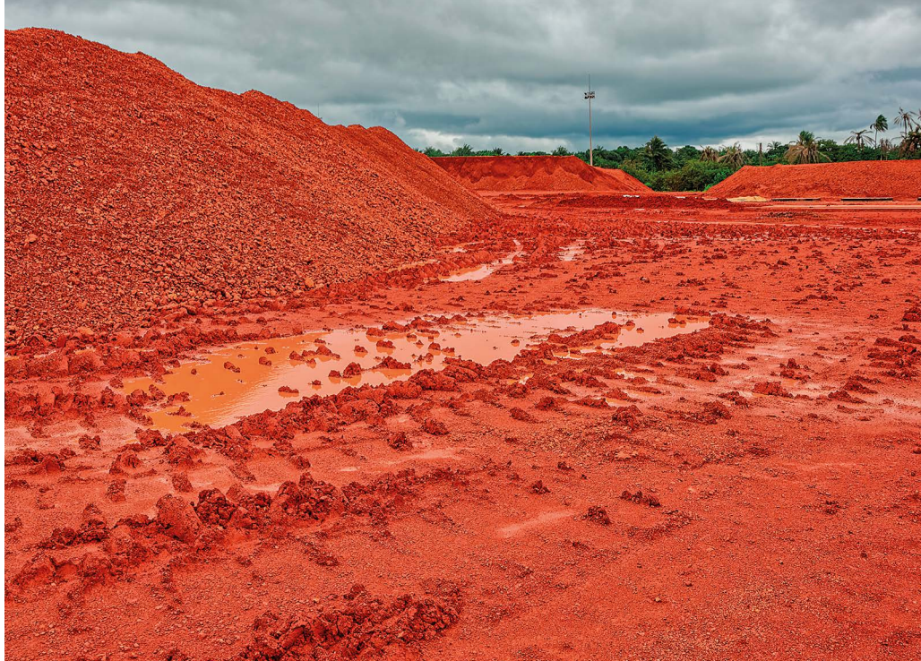
Forvirringsprocesser i tropejord gør, at værdifulde metaller som nikkel og aluminium bliver koncentreret i jorden. Men for at få fat i de værdifulde mineraler må regnskov ryddes, og udvindingen af metallerne producerer store mængder giftigt affald. På billedet ses mineaffald fra aluminiumproduktion i Guinea i Vestafrika. Foto: Shutterstock
