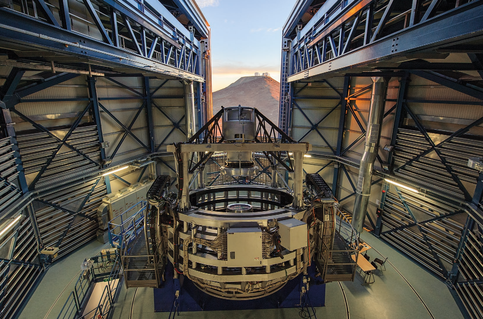
Det europæiske teleskop VISTA i Chile er blevet udstyret med en spektrograf, så astronomerne kan analysere lyset fra de cirka 200.000 kvasarer, de forventer at finde ved hjælp af rumteleskopet Gaia. Foto: G. Hühdepohl (atacamaphoto.com)/ESO
