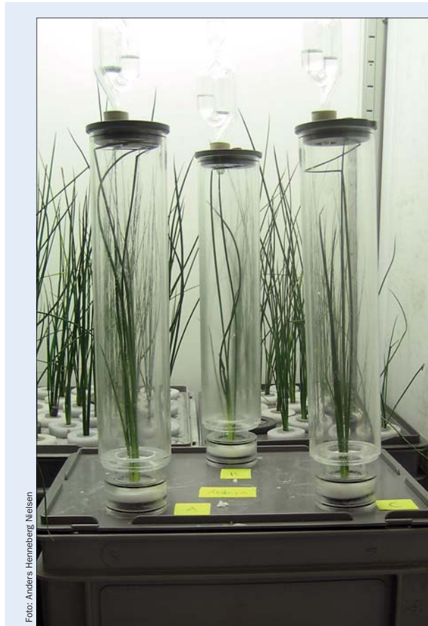
Figur 2. Forsøgsopstillingen (foto) og udvalgte resultater fra vores undersøgelse af \text{CH}_4 -transporten i lysesiv. Planternes rødder når ned i den grå kasse, der er fyldt med vand, næring samt \text{CH}_4 . Planten er forseglet, så den gas, der slipper op i det øverste kammer, kun kan komme gennem planten.
