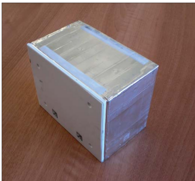
En enkelt "mursten" i OPERA-detektoren vejer ca. 8 kg, og består af 57 fotografiske film og 56 lag af bly.
