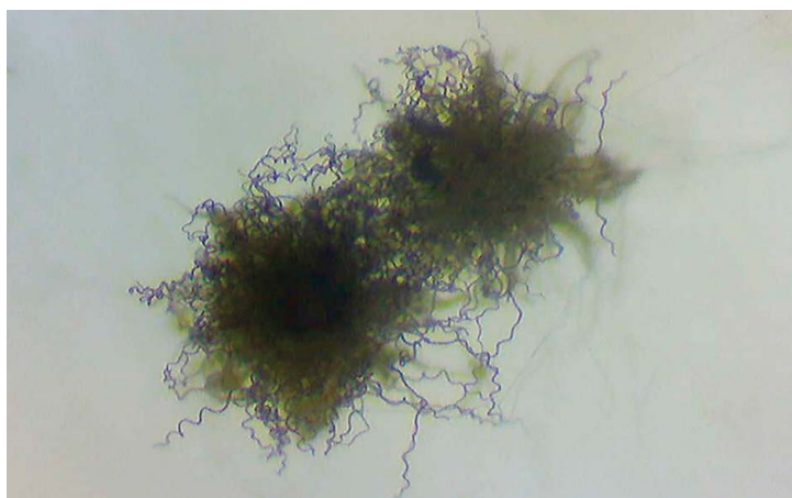
Chaetomium globosum , der vokser på en gipsplade. Billedet er taget direkte i stereomikroskop. Foto: Birgitte Andersen
