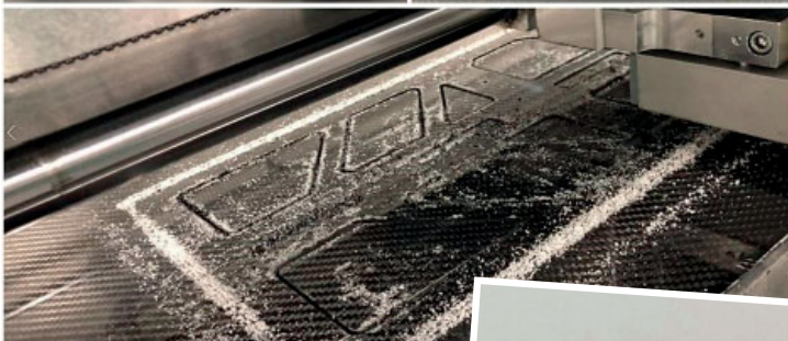
Komponenterne til satellit-strukturen fremstilles og samles i SDU's højteknologiske kompositlaboratorie i Hans Christian Andersen Lufthavnen. Fotos: Nicolai Iversen.
