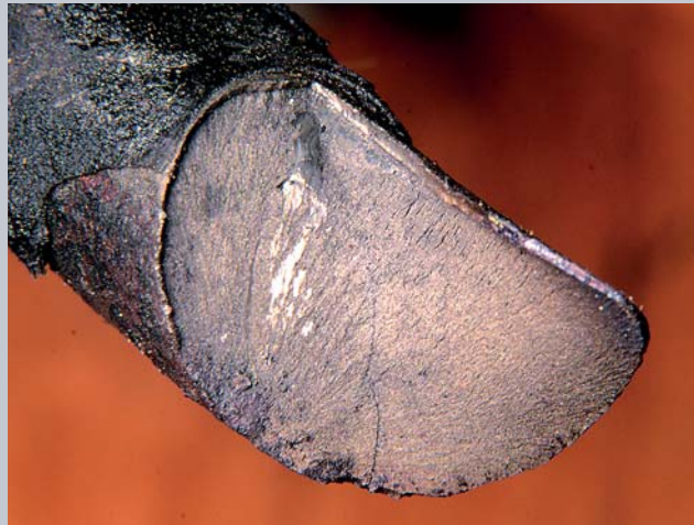
Nærbillede af et brud forårsaget af metaltræthed i en fjeder fra en bil. Der ses også flere mindre revner, som også er begyndende træthedsbrud.
