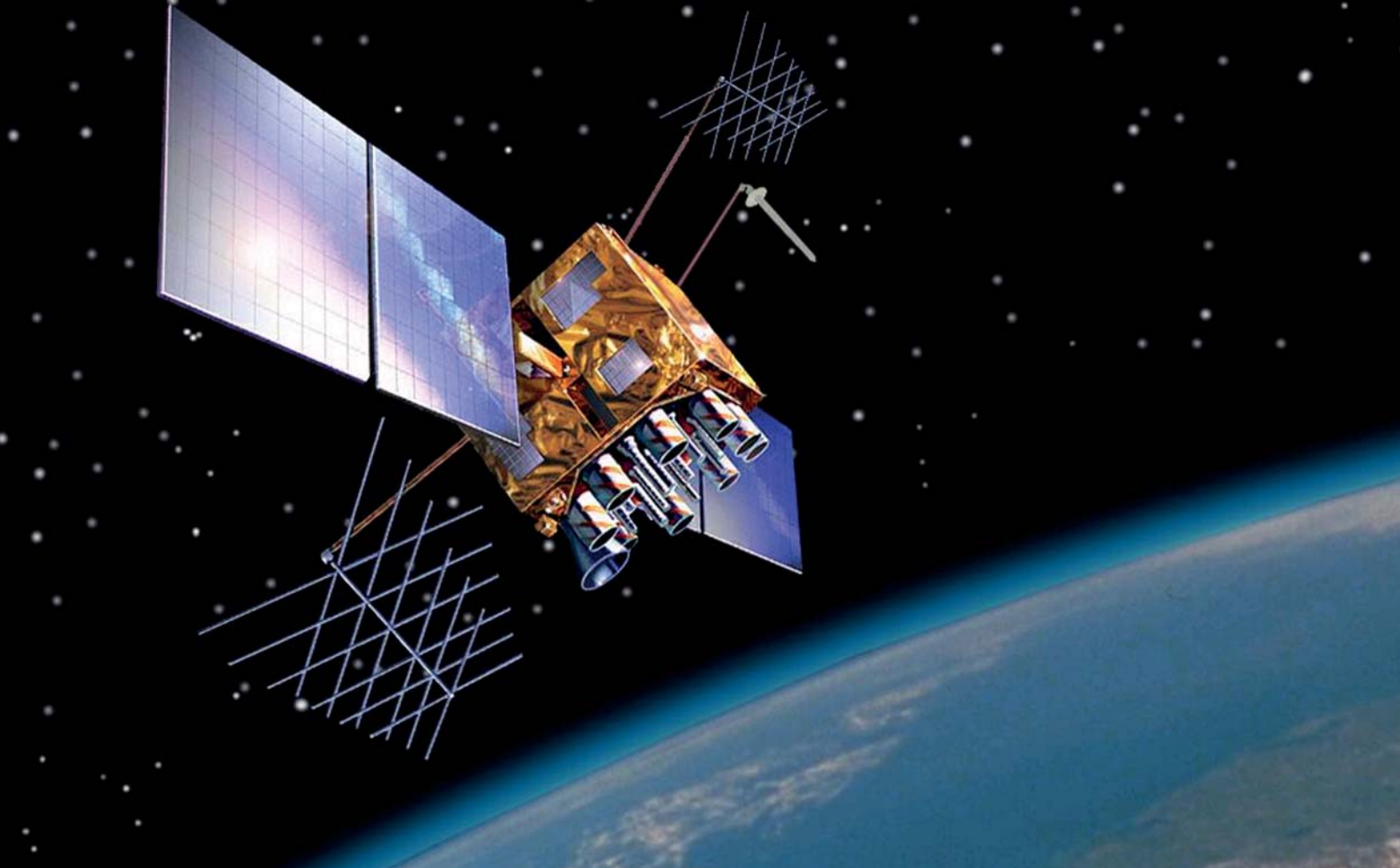
GPS-satellitter er en slags "anvendt relativitetsteori". Hvis man ikke tager hensyn til, at et ur i bevægelse går langsomt og at et ur længere ude i tyngdefeltet går hurtigt, vil GPS-systemet ophobe en fejl på ca. 8 m i minuttet. Illustration: US Government
