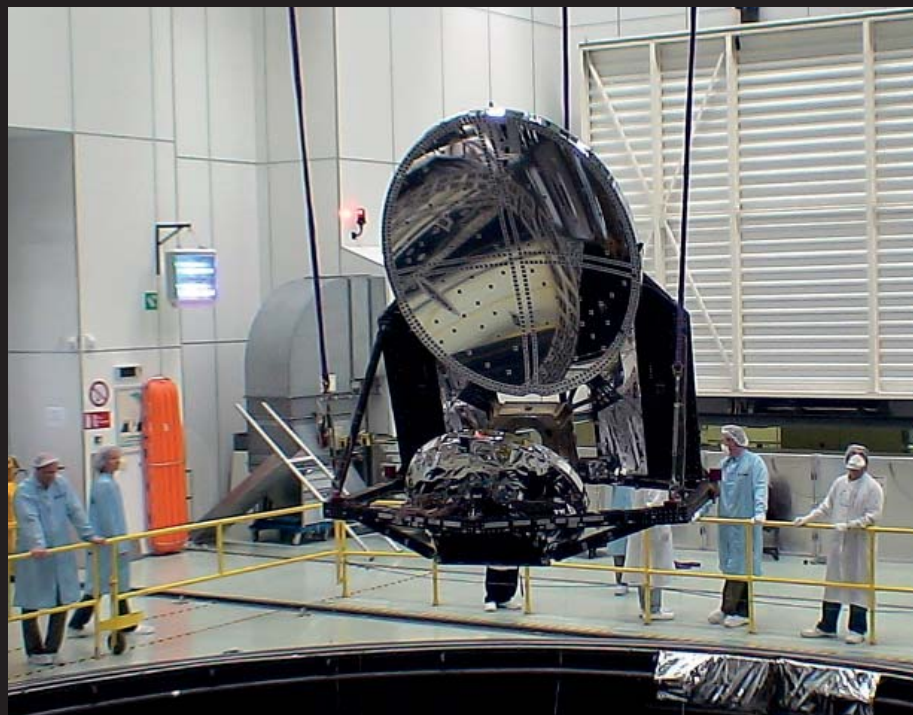
Planck-teleskopet under afprøvning. Hovedspejlet er ca. 1,9 meter højt og 1,5 meter bredt, mens det mindre sekundær-spejl er ca. 1 meter i diameter.
