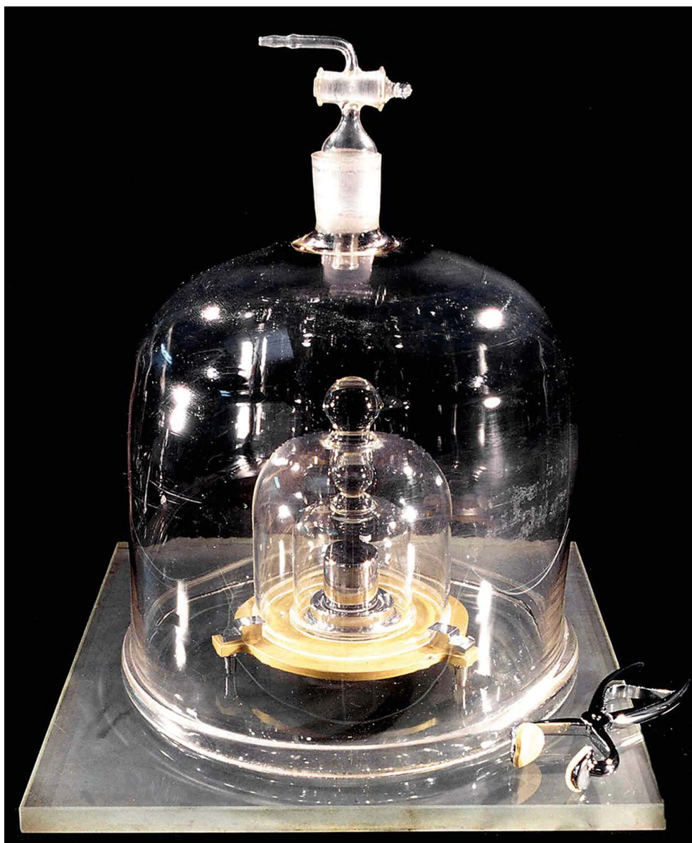
Den internationale prototype fra 1879 af kilogrammet, forkortet IPK og ind imellem kaldt Le Grand K. Det er en cylinder på ca. 39 mm i højde og diameter, som er lavet af en legering af 90 % platin og 10 % iridium (densitet ca. 21.500 kg/m 3 ). Hele tre glasklokker beskytter Le Grand K.
