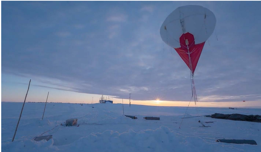
Fotoet viser en ballon til aerosolmålinger i højden samt en stationær målestation ved Villum Research Station i Nordgrønland i forbindelse med feltkampagnen CleanCloud Arctic Spring i 2024. Foto: Lionel Favre (EPFL).
