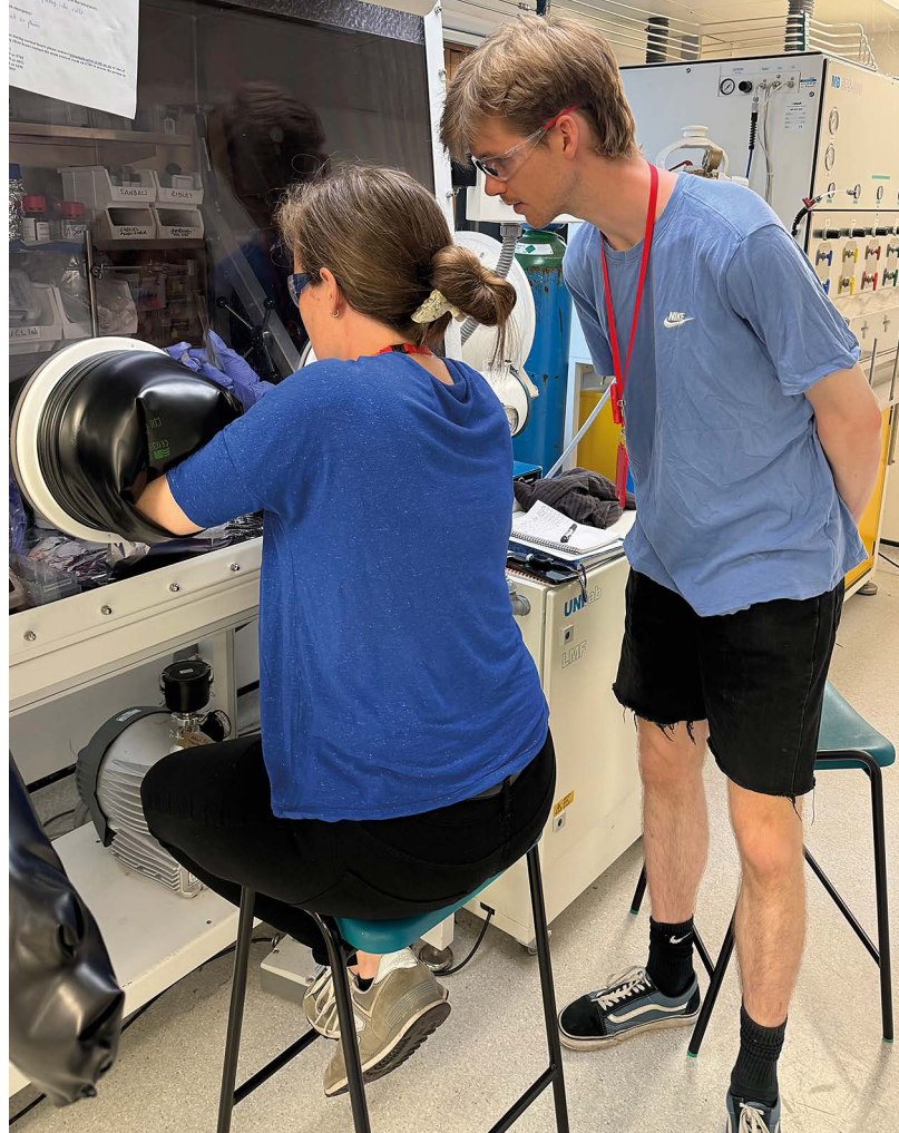
Elsbeth J. Pedersen og Anders K. R. Christensen arbejder i en handskeboks med vandfølsomme prøver, der skal forberedes til neutronsprekings eksperiment ved forsøgsreaktoren ISIS i England. Foto: Morten M. Smedskjær
