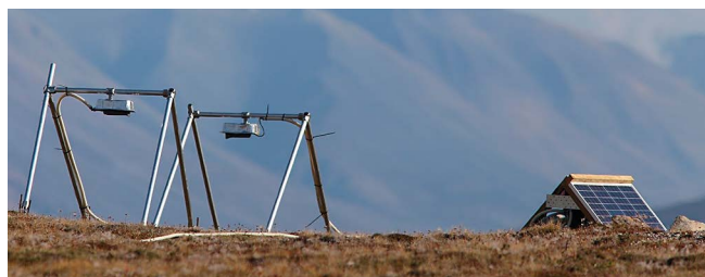
Kameraer monitorer insekter på tundraen i Østgrønland. Foto: Toke T. Høye
