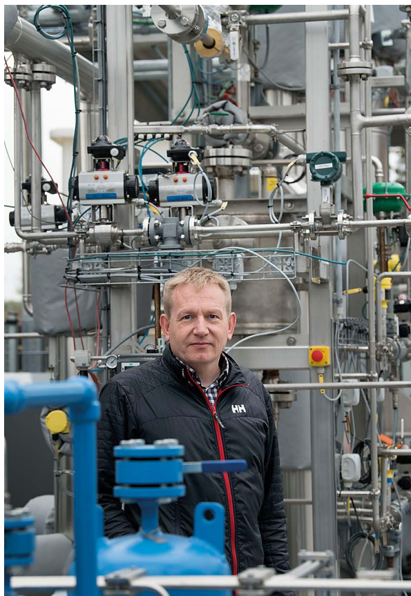
Demonstrationsanlægget ved Aalborg Universitet producerer Methanol til brug i for eksempel tung transport ud fra CO 2 og hydrogen samt strøm fra vedvarende energi. Foto: Lars Horn
