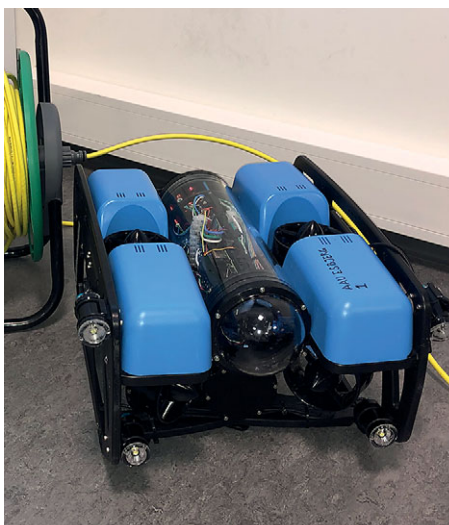
Den første udgave af undervandsrobotten med højtryksrenser, propeller, lys og elektronik i midten. Privatfoto Foto: Cecilia Cerretani
