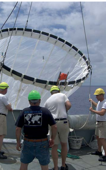
Fiskeri efter ålelarver på Galathea 3. Et 3,5-meter ring net til fangst af fiskelarver. Nettet har en maskestørrelse på bare 0,55 mm
