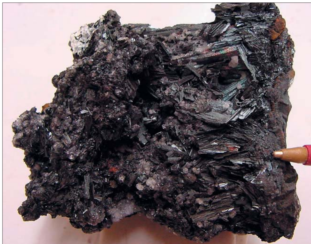
Grundstoffet jern har den største bindingsenergi af alle kerner. Jern findes normalt ikke frit, men er bundet i mineraler som f.eks. hæmatit, som er et jernoxid.
