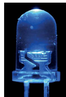
Udviklingen af blå lysdioder har banet vejen for LED-lyskilder med hvidt lys.
