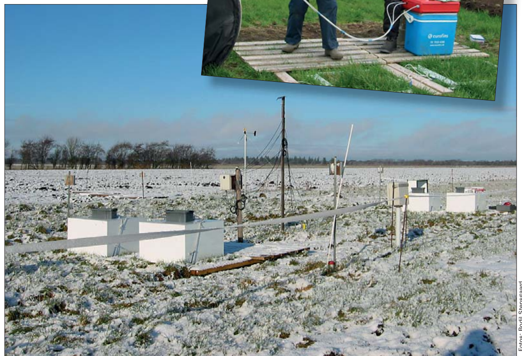
På udvalgte marker blev der udpeget 3 x 2 felter til måling af gasudvekslingen mellem jord og atmosfære. Desuden var der udstyr til måling af klimavariabel, grundvandsstand mm.
