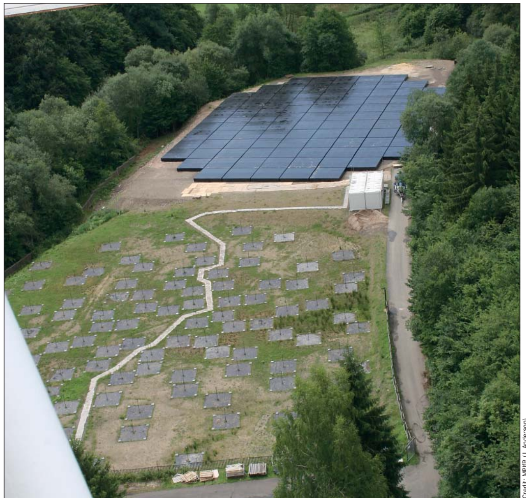
En af de tyske LOFAR-stationer ligger ved Bad Münstereifel-Effelsberg i nærheden af Bonn. Forrest ses de lodrette rør, der udgør LBA, og bagerst de mørke HBA-paneler. Stationen dækker et område på omkring 130 x 60 meter.
