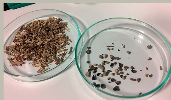
Sorteringsprocessen af mulige mikroplastkandidater. Petriskålen med mindst materiale indeholder mulige mikroplastkandidater og den anden det frasorterede, organiske materiale (i dette tilfælde græsstrå). Foto: Kristina Borg Olesen
