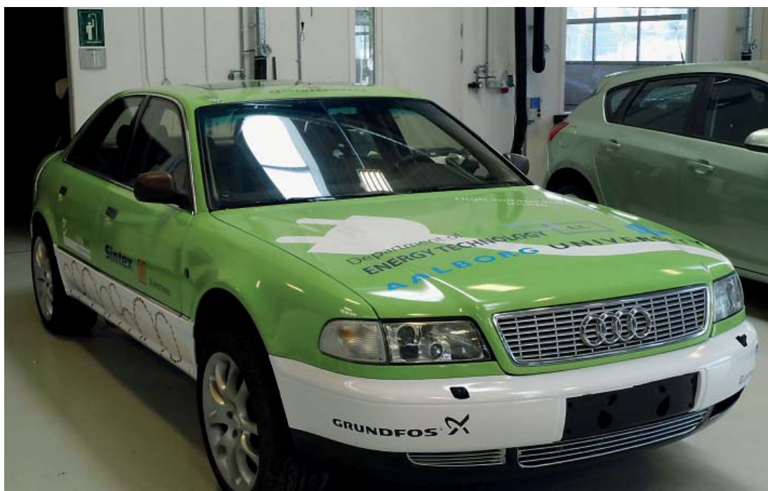
Bil konverteret om til eldrift af Aalborg Universitet, Institut for Energiteknik i forskningsprojektet "Fremtidens højeffektive elbil integreret i elsystemet". I projektet blev der udviklet egne elmotorer, en 38 kWt-800 V batteripakke, samt den nødvendige effektelektronik og styring.
