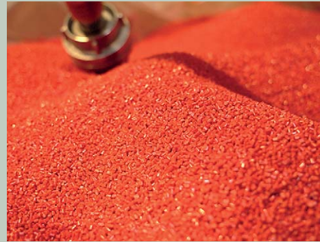
Granulat af ABS-plast er råmaterialet til de fleste af LEGOs elementer. Foto: LEGO.
