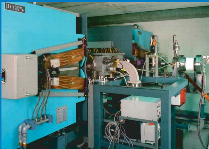
Vores "mikrotron" på Institut for Fysik og Astronomi ved Aarhus Universitet, som vi har brugt til eksperimenterne, der skal bane vejen for en fremtidig "diamant-maskine".
