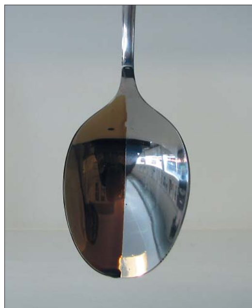
Billedet viser en ske, der på den ene halvdel har fået en olieafvisende belægning. Når skeen dyppes i råolie, løber olien hurtigt af den behandlede overflade, mens den bliver hængende på den ubehandlede halvdel.
