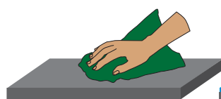
Overfladen rengøres og aktiveres evt. med såkaldt plasmabehandling
