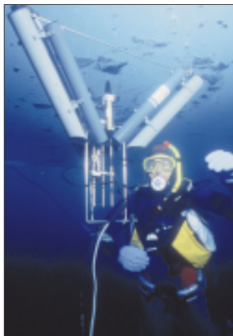
De tynde iltelektroder bores op i undersiden af havisen, hvor de måler, hvor meget isalgerne producerer.
