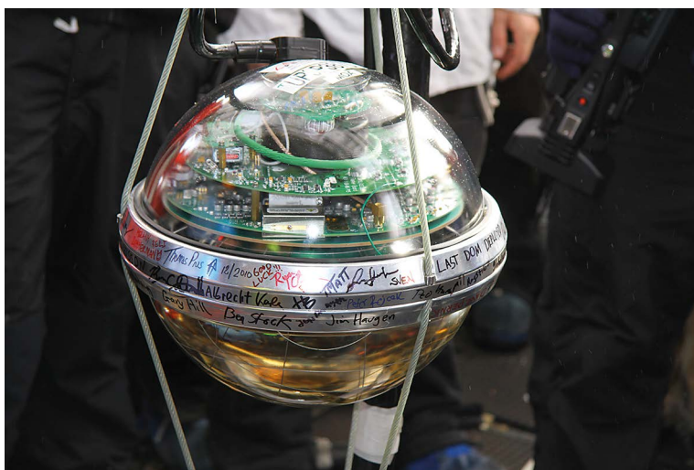
Billedet viser det sidste af de 5.196 digitale optiske moduler, der blev installeret i IceCube-observatoriet og dermed fuldførte detektoren.
